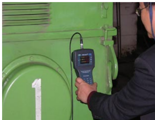
HV Motor PD Testing – TEV & CT
