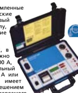
Испытательный постоянный ток, в котором отсутствуют пульсации, можно изменять от 5 А до 600 А или до 200 А, в зависимости от модели; максимальный непрерывный ток составляет 300 А или 100 А соответственно. Прибор имеет диапазон измерений до 1 Ом с разрешением до 0,1 мкОм в зависимости от измеряемого сопротивления. Оснащенные портом USB для загрузки данных приборы серии Mj Iner добавляют дополнительный уровень безопасности оператору благодаря дистанционному управлению.
