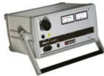
Одно замыкание на землю не приведет к перебою в работе системы, однако с появлением второго замыкания на землю существует высокий риск частичного или полного отказа установки, следовательно, любое замыкание на землю должно быть как можно быстрее найдено и устранено. GL660-1 может обнаруживать замыкания до 150 кОм даже в условиях сильных помех и не требует выключения системы.
