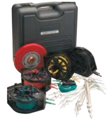
Все необходимое для измерения сопротивления заземления, в том числе прочный полиэтиленовый контейнер
