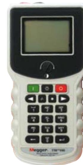
Принцип одноразового соединения – 3-фазные измерители коэффициента трансформации и сопротивления обмотки компании Megger позволяют сделать соединения один раз и выполнить все испытания без переподключения проводов при тестировании другой обмотки. Это существенно ускоряет тестирование, особенно при испытаниях больших силовых трансформаторов с несколькими отводами. Измерительные провода подходят для обеих серий, TTR300 и MTO300.
