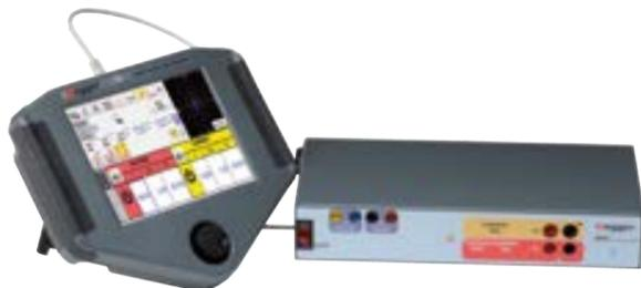
Имея вес всего лишь 3,2 кг, SMRT1 является очень эффективной системой проверки реле. При одном генераторе (источнике) тока и одном генераторе (источнике) напряжения, канал тока выдает 60 А при 400 ВА, тогда как канал напряжения выдает до 300В или может быть преобразован в канал тока, выдающий непрерывно 15 А, 150 ВА
