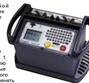
DLRO600 измеряет сопротивления в диапазоне 0,1 мкОм - 1 Ом при сильных токах. Он может обеспечивать испытательные токи от 10 А до 600 А в зависимости от сопротивления нагрузки и напряжения питания. Это идеальный прибор для проверки сборных шин.
