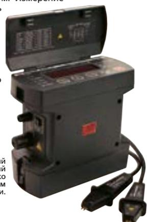
DLRO10 имеет яркий светодиодный 4 1/2 разрядный экран, позволяющий легко считывать показания при любом освещении.
